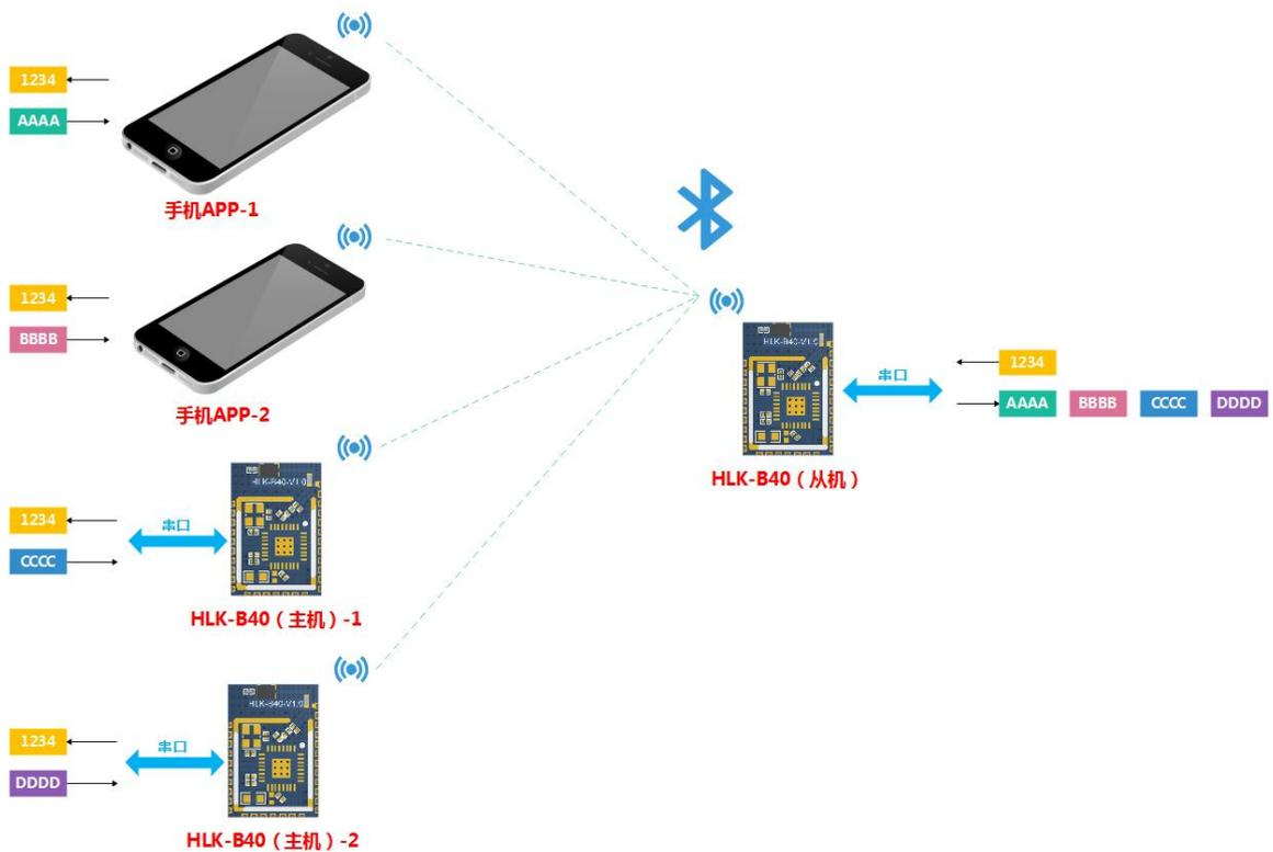
图 2 多对一蓝牙连接透传功能示意图
